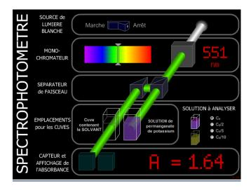
Pour une longueur d'onde donnée, l'absorbance A d'un échantillon représente le rapport de l'intensité de la radiation incidente I<sub>0</sub> sur l'intensité de la radiation transmise I :
