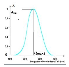
Un spectre UV- visible se décrit en indiquant les valeurs de la longueur d'onde au **maxima d'absorption**, notées  $\lambda_{max}$ , et les **coefficients d'absorption molaires**  $\epsilon_{max}$  correspondants. Le couple  $(\lambda_{max}, \epsilon_{max})$  caractérise une espèce chimique absorbante dissoute dans un solvant donné à une température donnée.
